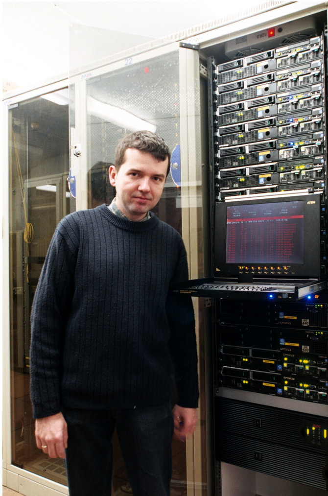
Rysunek C.1. Klaster Clusterix i autor stojący obok klastra. Zbudowany z dwunastu dwuprocesorowych komputerów wyposażonych każdy w dwa procesory Itanium 2 1,4 GHz, 4 GB pamięci operacyjnej i 74 GB pamięci dyskowej. Maszyna stanowiła lubelski moduł Krajowego Klastra Linuksowego [36] wdrażanego w latach 2004–2005. Autor w ramach projektu Clusterix przeprowadzał symulacje wielkiej skali kory mózgowych ssaków wykorzystując pakiet GENESIS w wersji równoległej. (Fot. Stefan Ciechan)
